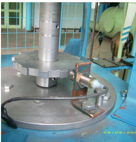
Фиг.3. Диск и преобразувател за честота на въртене
